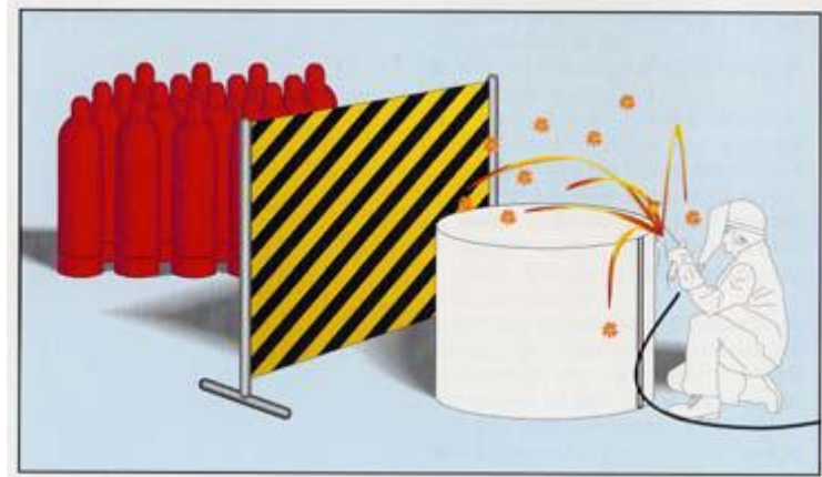
Resim 7.Sıçrayan Kıvılcımlara sebep olan bir çalışmada perdeleme
